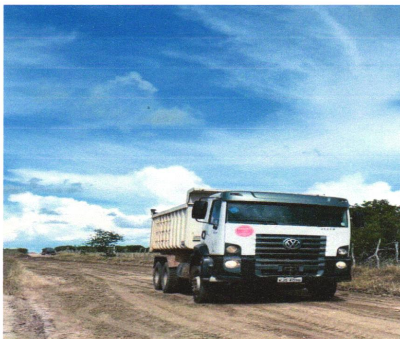
Foto 07 - TRANSPORTE COM CAMINHÃO BASCULANTE DE 10 M 3 , EM VIA URBANA EM LEITO NATURAL (UNIDADE: M3XKM). AF_07/2020
